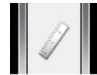
optiunea **calibrate**, se masoara pipa apoi se introduce valoarea reala de muscat (12,9 mm), acum imaginea este calibrata si dimensiunile masurate vor fi, cu o toleranta minima, reale.
